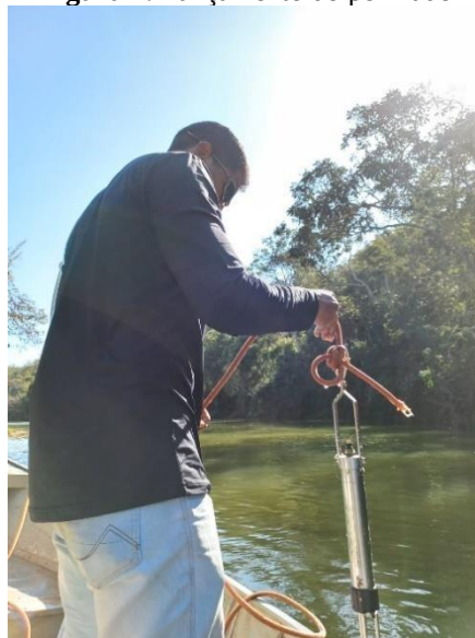
Figura 7. Lançamento do perfilador
