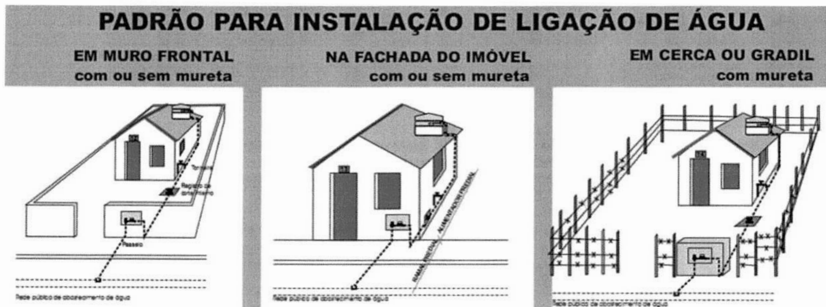
Figura 2 - Modelos de Locais para Instalação da Caixa Padrão de Hidrômetros
