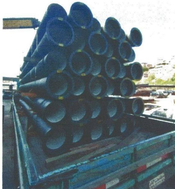
*Figura 11: Tubos de ferro fundido*
