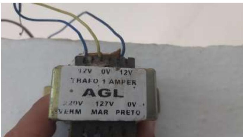
**Figura 4:** Transformador da fechadura eletrônica.
