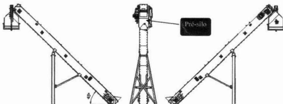
Figura 39 - Vistas do Sistema de elevação e descarga de material
