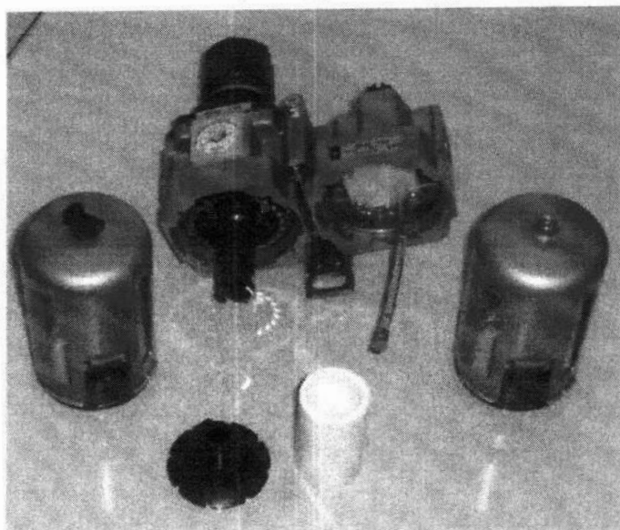
Figura 42- Unidade de tratamento desmontada
