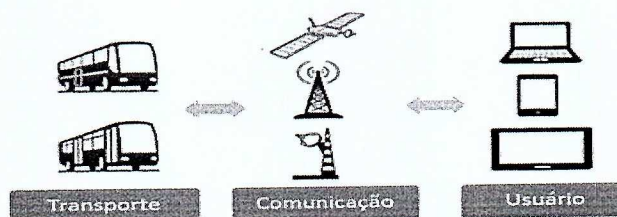
Figura 21. Esquema de funcionamento do sistema GPS para monitoramento do transporte coletivo
