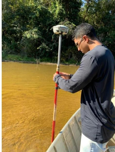
Após a coleta dos dados com a metodologia RTK, os dados são integrados com os pontos da batimetria para uma melhor representação do reservatório.
